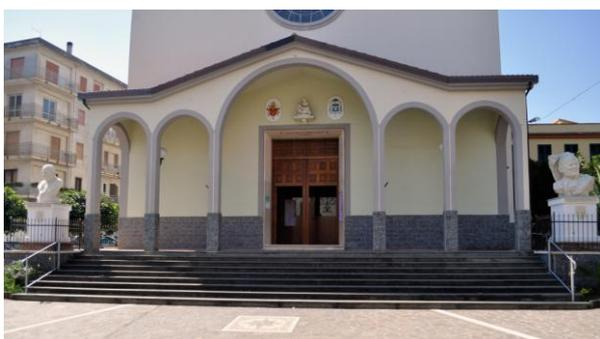
La chiesa, a navata unica molto grande, è chiusa da un'importante abside e da cappelle laterali ed è stata eretta con l'uso del cemento armato per le strutture portanti e pietrame listato per le murature.
